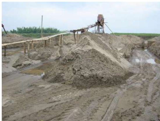
Figura II-3. Sistema descargue material extraído.
