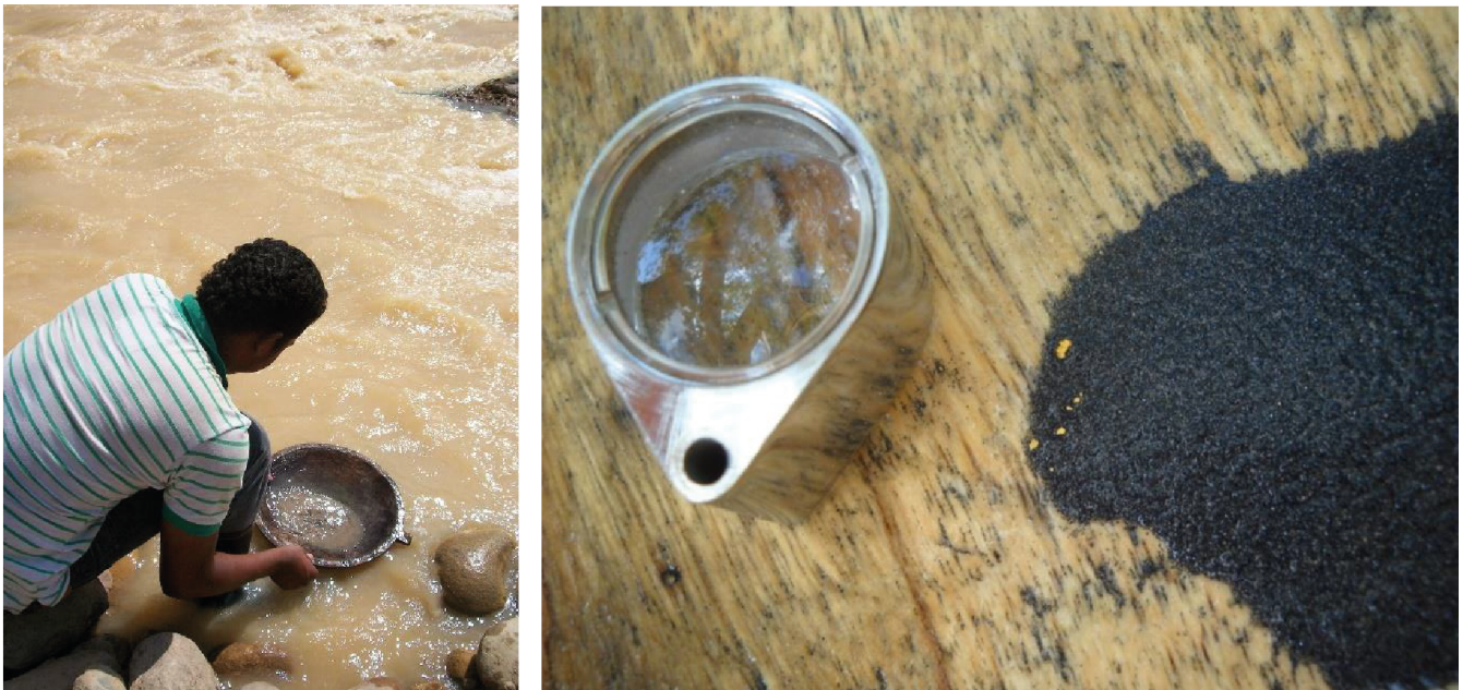
Figura 13. Obtención de concentrados para análisis de laboratorio Fuente: autores
