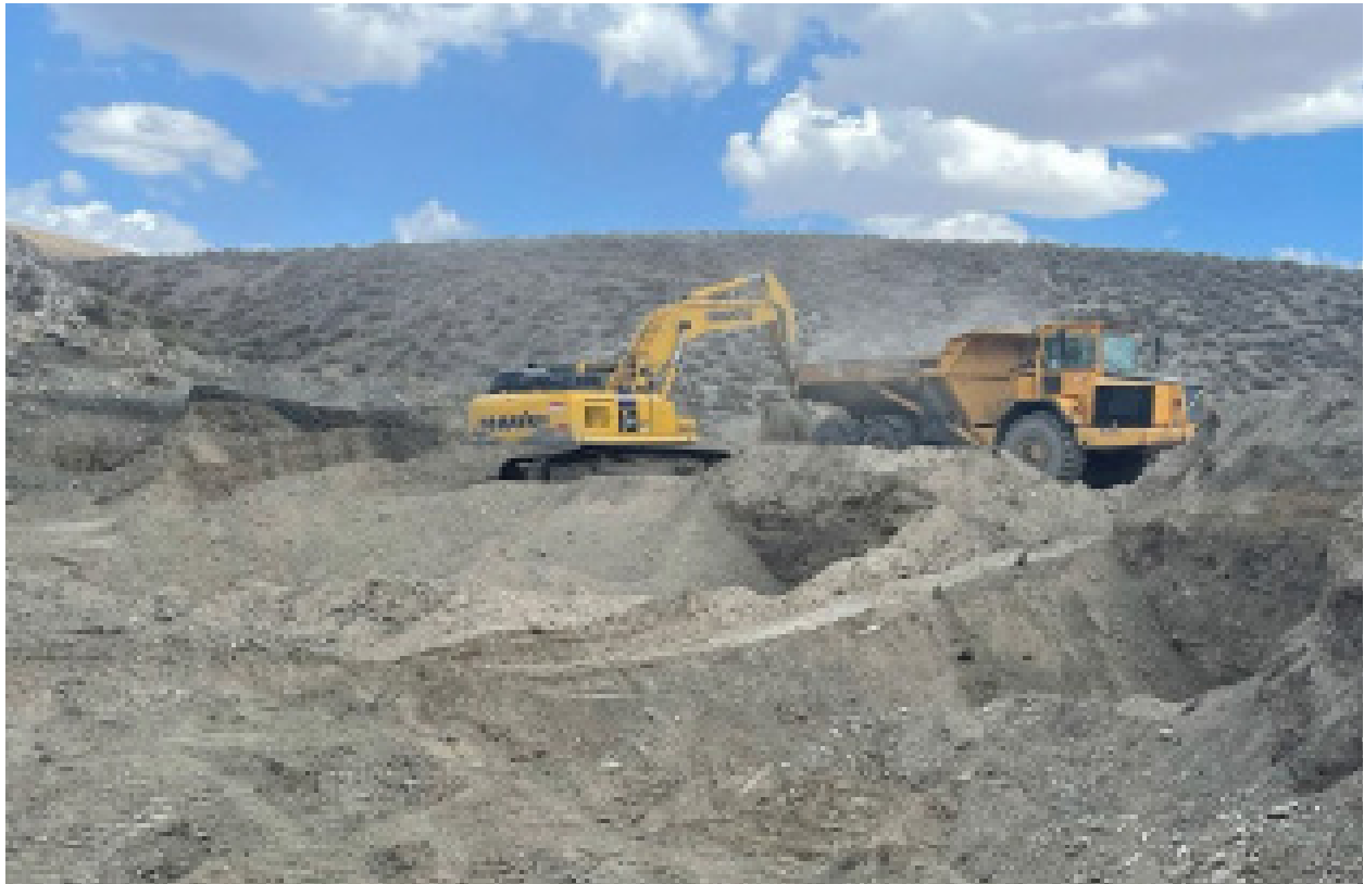
Figura 32. Operación en depósito de placer con el método de volqueteo Fuente: autores
