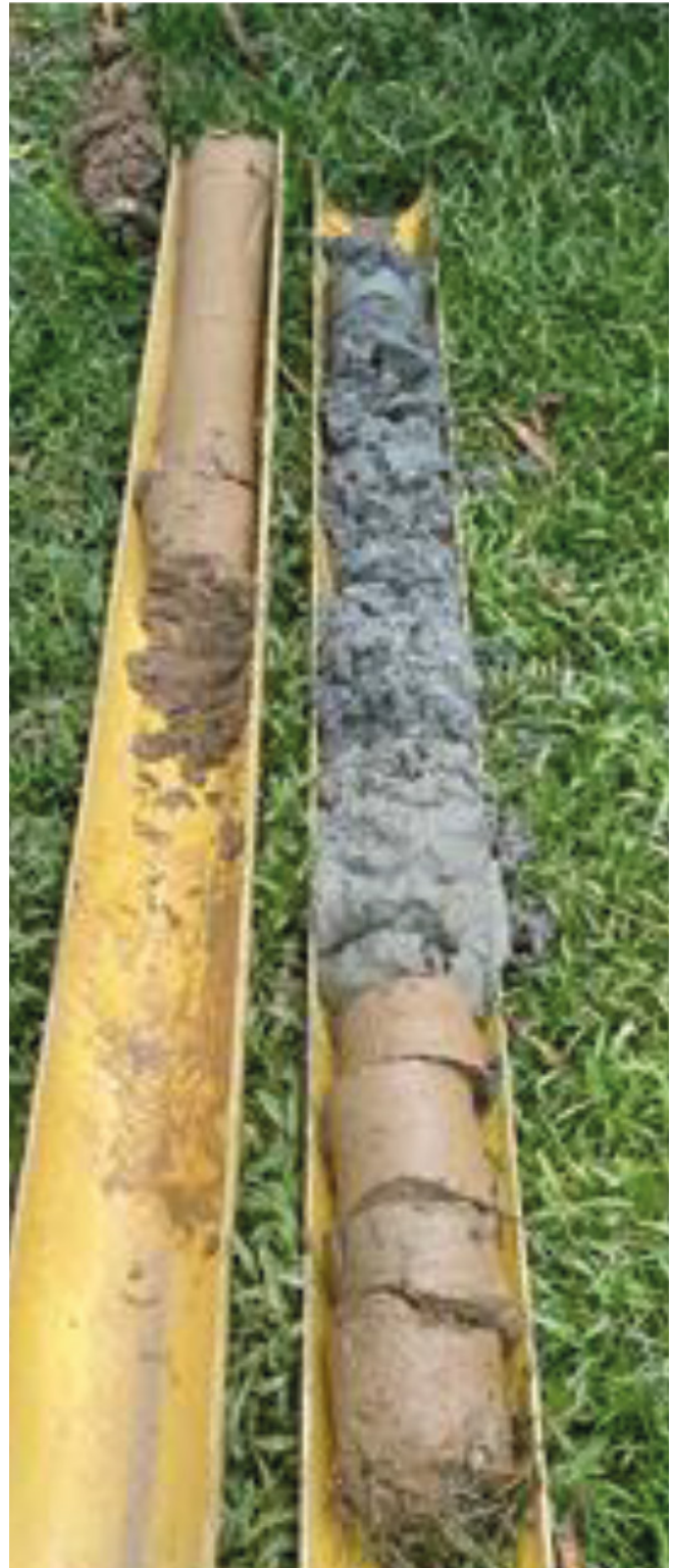
Figura 19. Núcleo de perforación con taladro Roto Sónico Fuente: autores
